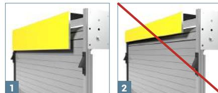
L'articulation du rideau autour de la roulette avant de rejoindre l'enrouleur **ne doit pas être visible de l'extérieur** du véhicule (le rideau doit rester bien droit) (*photo 2*).
