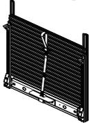
Système permettant l'ouverture du rideau de l'intérieur du compartiment.
