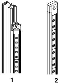
Eclairage par LED CMS installé sur l'arrière des rails (1), ou sur tout autre surface plane (2) dans un profilé alu adapté à l'une de ces 2 demandes. Si vous souhaitez une hauteur particulière d'éclairage, veuillez indiquer dans la case "hauteur souhaitée" la dimension. Sans précision de votre part, nous livrerons cet équipement à la hauteur maximale possible selon votre hauteur d'ouverture.
